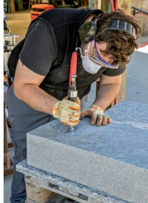
▲ Con il bocciardino, Raul rende la superficie delle lastre ancora più ruvida per soddisfare le esigenze del cliente.
